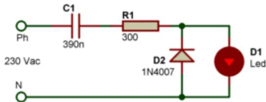
La résistance R1 limite l'appel de courant quand le condensateur est déchargé. Sa valeur doit être déterminée en fonction de la capacité du condensateur et de la pointe de courant que l'on accepte, mais de manière générale, on estime que sa valeur doit être de l'ordre de
