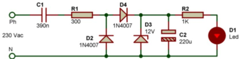
La diode D4 empêche effectivement le condensateur de se décharger lors des alternances négatives. Et cette fois, nous disposons bien d'une tension continue, stabilisée et filtrée, aux bornes de la diode zener D3. Le calcul de C2 répond approximativement à la formule suivante :
