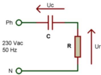
Mais la formule  $R = U / I$  que l'on utilise pour calculer la valeur d'une résistance en fonction de la chute de tension qu'elle doit provoquer sous un courant donné, ne convient pas (voir page Abaissement tension). Au lieu de cela, nous devons utiliser une formule où apparaît un terme lié à la fréquence de la tension alternative à abaisser (50 Hz du secteur 230 V, en ce qui nous concerne).
