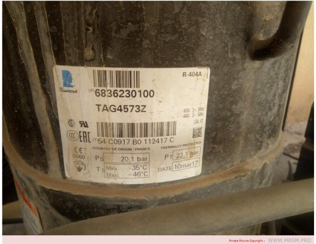
Mbsm.pro, Compressor, AGB4573ZKZ , TAG4573Z , 6.5HP, R404A, MHBP, TAG4573Z-V, Compresseur Hermétique, Tecumseh
