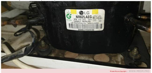
Mbsm.pro, compressor, Lg, Nr 62 lAEG, Nr62lAEG, r-134, 1/5 hp
