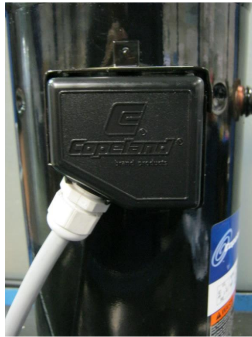
Figure 14 : Installation correcte avec presse-étoupe, boîtier électrique en IP21 (modèles ZB15K* à ZB45K*)
