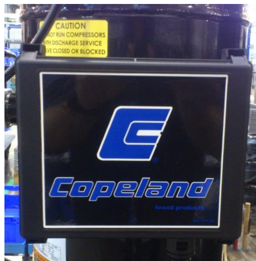
Figure 15 : Installation correcte avec presse-étoupe, boîtier électrique en IP54 (modèles TW*)
