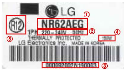
<R12 compressor label>
