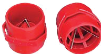
Slika 20.4. Alat za obradu spoljnih i unutrašnjih ivica cevi
