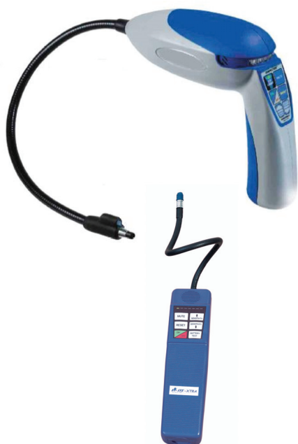
Slika 20.19. Elektronski detektor za utvrđivanje propustljivosti rashladnog fluida
