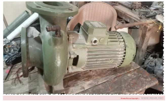
Mbsm.pro, Moteur aspiration de surface, Ir80-160/f, Saer, 10 hp, 400 v, 3 ph
