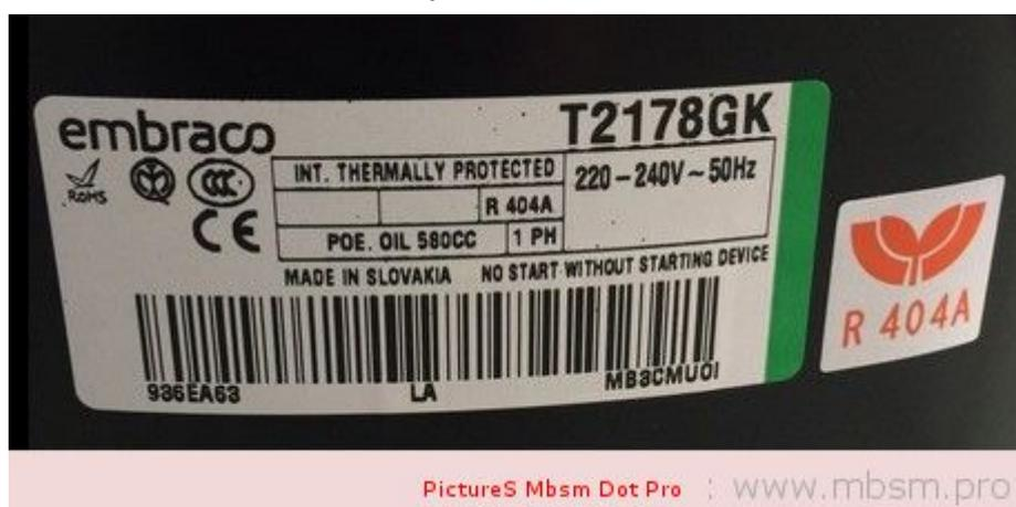
Mbsm.pro , Compresseur frigorifique, Embraco Aspera ,T2178GK , 1Hp ,PIÈCES FRIGO, 404A , 220-240 V 50 Hz
