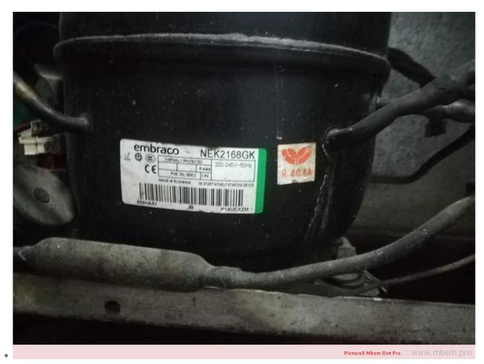
mbsm.pro , Compresseur Aspera , Embraco NEK2168GK , R404A , LBP ,3/4 HP Compresseur hermetique de Aspera - Embraco NEK2168GK - R404A 3/4 HP 220-240V 50 Hz Cylindrée = 14.3 CM3 APPLICATIONS = LBP Moteur type: CSR
